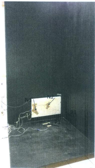
Sl. 3 Pozicija grijajuće ploče i mjernih sondi u ispitnom kutu
